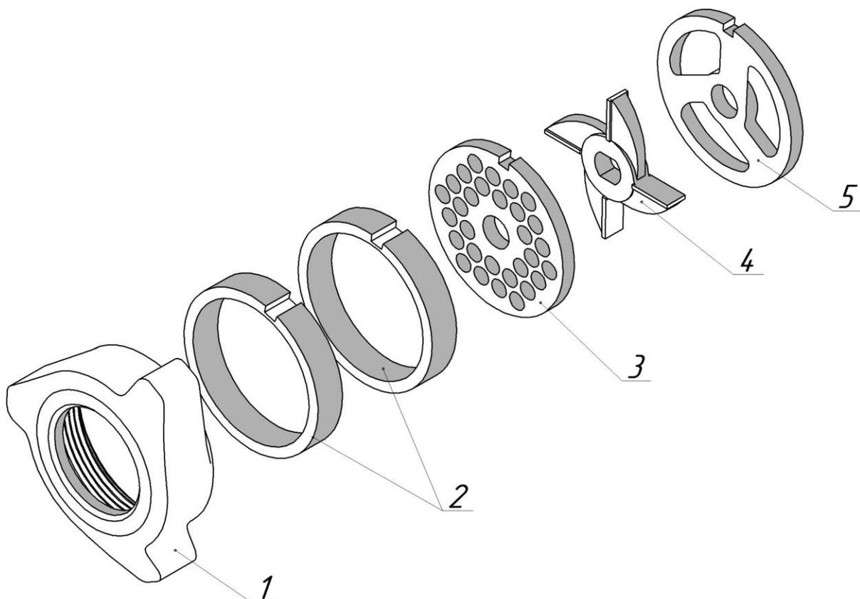
**Рисунок 5 – Набор для крупной резки мясорубки «полунгер»**
