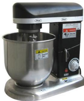
Вы приобрели планетарную тестомесильную машину. Тестомесильная машина оснащена переключателем скоростей перемешивания и специально разработанными дежой и мешалкой, обеспечивающими более качественное перемешивание. Машина достигает от 0 до 1000 оборотов в минуту, что позволяет использовать ее для широкого спектра операций взбивания и перемешивания, например, замешивания теста, взбивания яиц и т.д.
