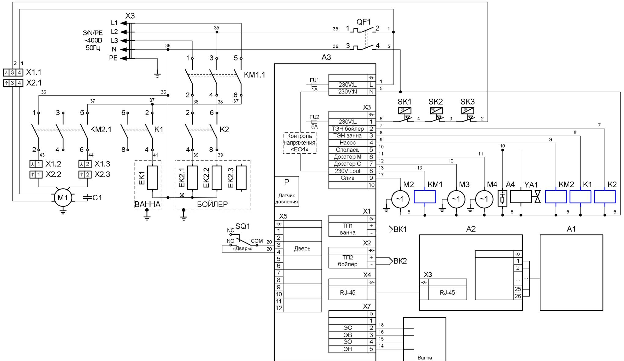
СХЕМА ЭЛЕКТРИЧЕСКАЯ СОЕДИНЕНИЙ МПК-500Ф, МПК-500Ф-01, МПК-500Ф-02
