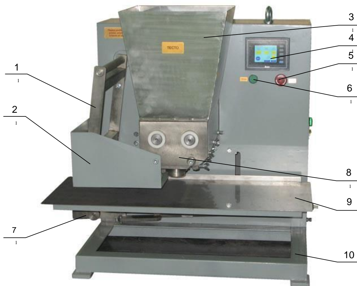
Рисунок 1 Универсальный кондитерский формовочный станок «Уникон» 1 – механизм струнной резки, 2 – защитный кожух механизма струнной резки, 3 – бункер, 4 – сенсорный экран управления станком, 5 – кнопка «Пуск», 6 – кнопка аварийной остановки «Стоп», 7 – рычаг подъема стола, 8 - узел подачи теста, 9 – стол, 10 – корпус станка
