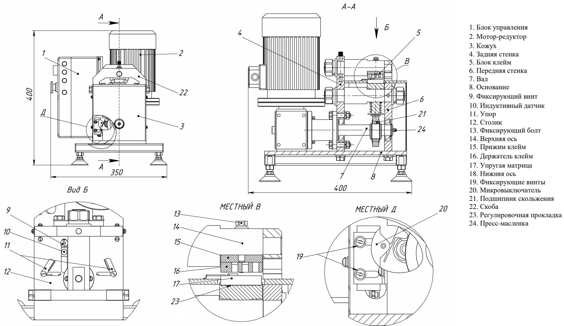
Рисунок 1. Машина укупорочная (маркировка крышек) ИПКС-127М
