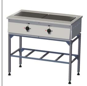
На плиту установлены чугунные электрические конфорки, типа КЭ-0,12, с размерами 417х290мм, мощностью 2,5кВт или 3кВт (при заказе мощность конфорок можно выбрать). Регулирование мощности конфорок – ступенчатое, 4-х позиционными пакетными переключателями.
