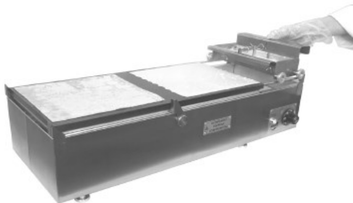
Фото 4. Одновременное обжаривание второй стороны блина и формирование следующей блинной заготовки.
