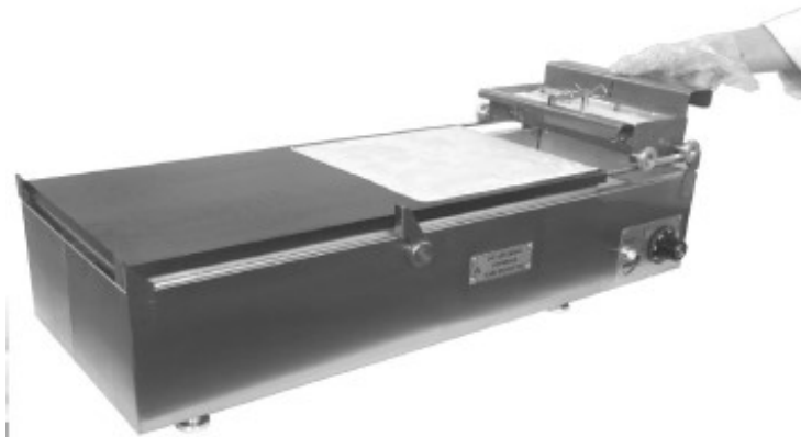
Фото 3. Формирование и обжаривание первой стороны квадратной блинной заготовки.
