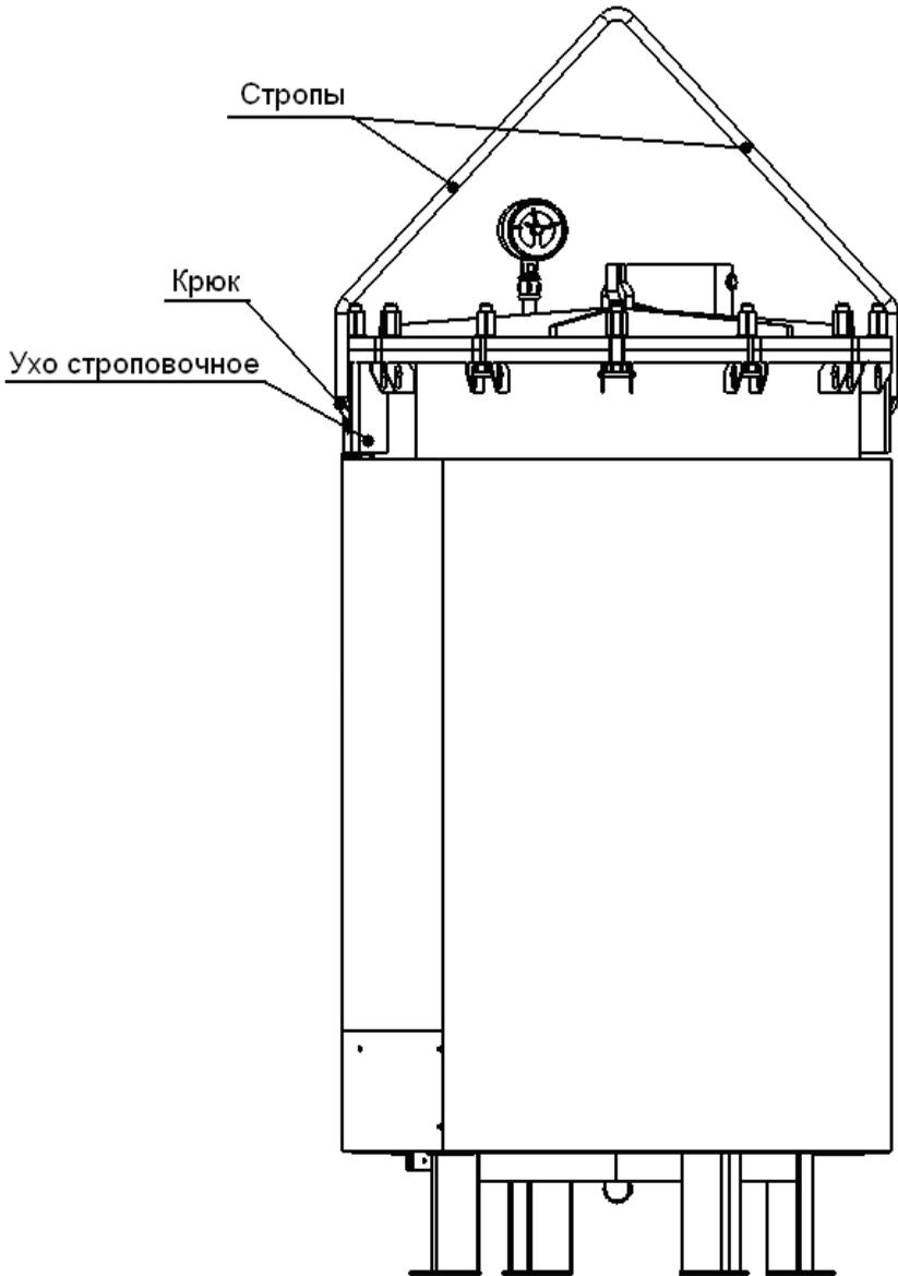
Рисунок 10. Схема строповки
