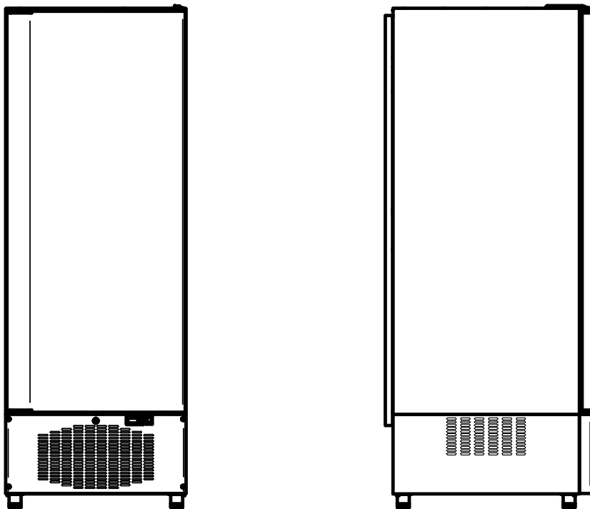
Рис. 1. ШХн-1,4-02; ШХн-1,4-03 с нижним расположением АКК
