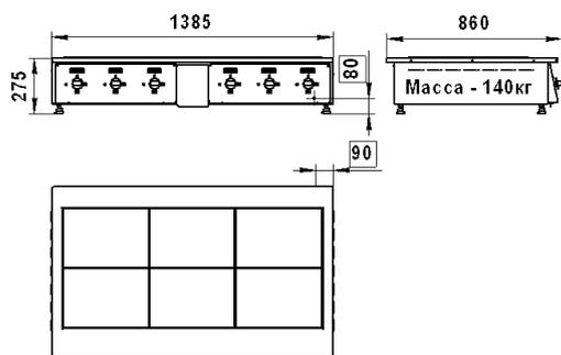
На плиту установлены чугунные электрические конфорки, типа КЭ-0,12, с размерами 417х290мм, мощностью 2,5кВт или 3кВт (при заказе мощность конфорок можно выбрать). Регулирование мощности конфорок - ступенчатое, 4-х позиционными пакетными переключателями.
