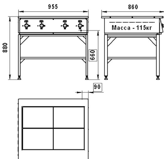
Размеры в рамке - место подвода электропитания, подвод электропитания с задней стороны плиты
